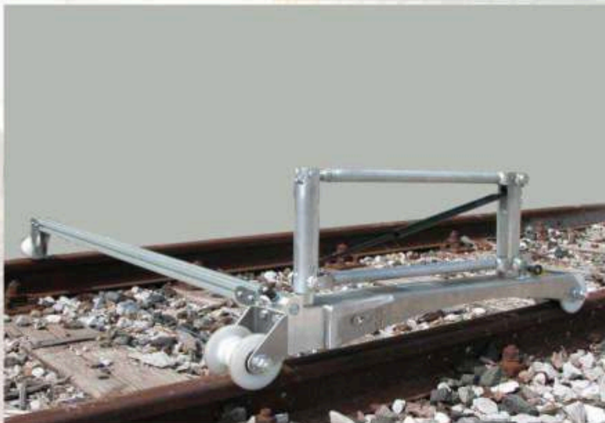
Carrello (opzionale) di supporto pieghevole in alluminio a tre ruote isolate.
